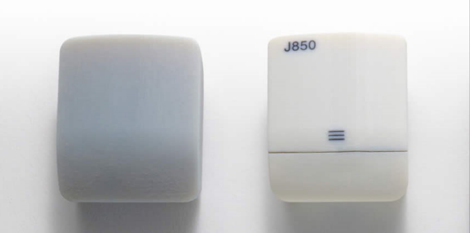
DraftGrey(왼쪽) 및 VeroPureWhite(오른쪽)로 3D 프린팅한 이어버드 케이스 프로토타입
