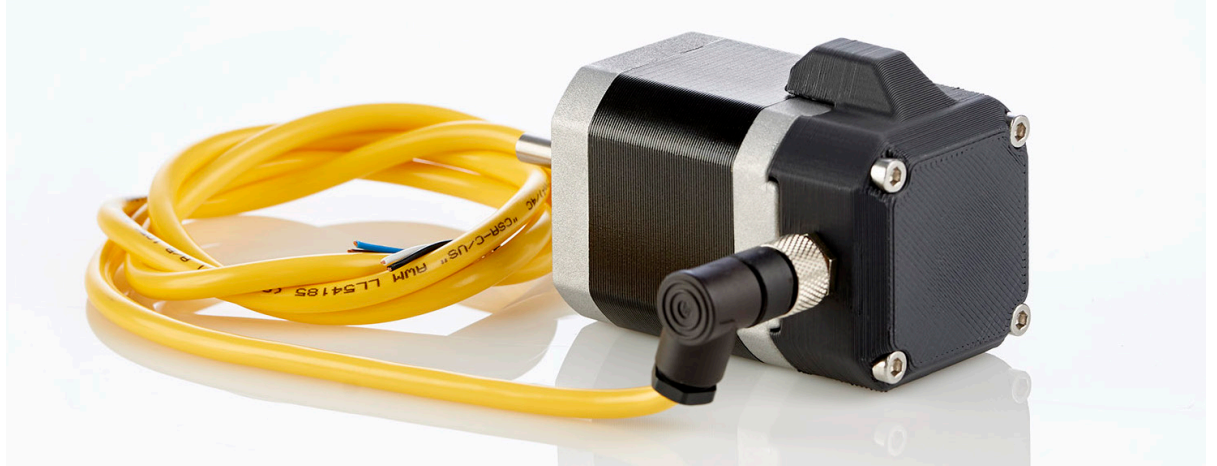
이 스텝터 모터의 엔드 캡은 제대로 맞춰지는지 확인하기 위한 기능 테스트용으로 3D 프린팅된 것입니다.
